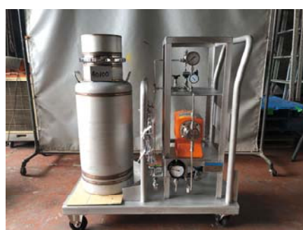
【非常用ポンプ注入式付臭装置】
