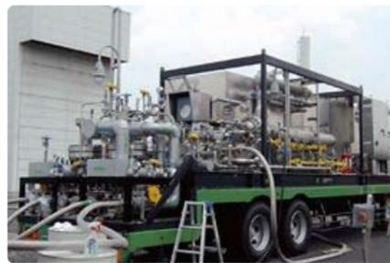
【トレーラー積載型 移動式気化装置】
