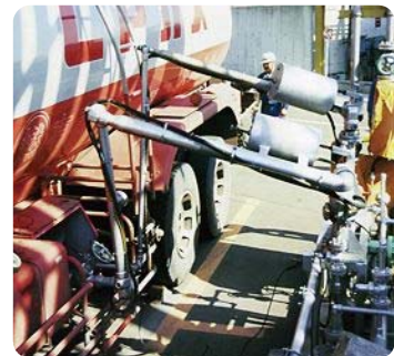
●TBニイガタローディングアーム ローリーからストレージタンクへの受け入れ
